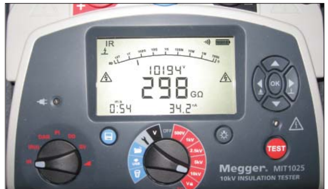
Figura 8: Panoul superior și afișajul Megger MIT1025
