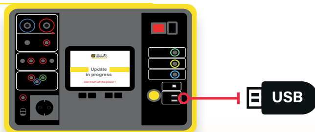
Actualizarea firmware-ului prin intermediul stick-ului USB
