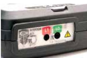
Mecanismul obturatorului facilitează utilizarea cordonelor corecte
