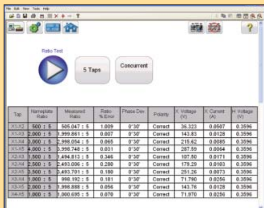
Ecran de test raport de transformare
