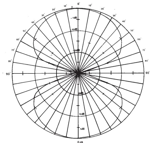
Du fait de l'anisotropie de la sonde EF1, pour effectuer une mesure, il est nécessaire de déplacer la sonde dans tous les plans, selon tous les axes (voir schéma) :
