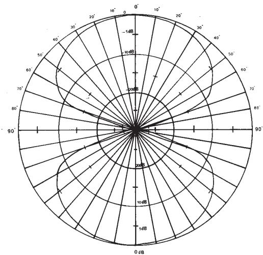
Wegen der Anisotropie der Mefsonde EF1 ist bei einer Messung die Sonde in alle Richtungen und Ebenen zu drehen (siehe Darstellung):
