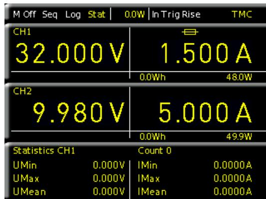
Abb. 5.3: Fuse-Anzeige CH1
