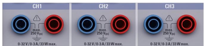
Abb. 1.3: Sicherheitsbuchsen auf der Gerätevorderseite
