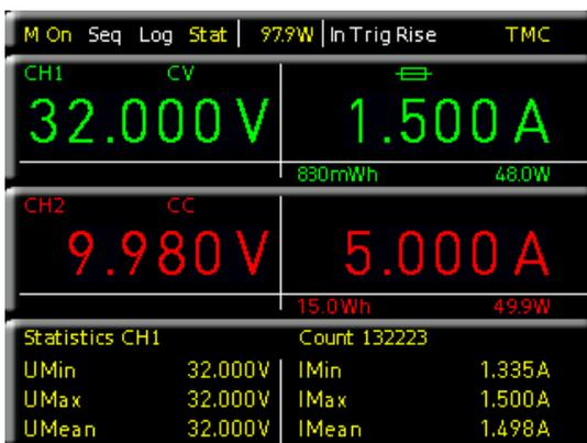
Fig. 5.2: Display values CV/CC R&S®HMC804x
