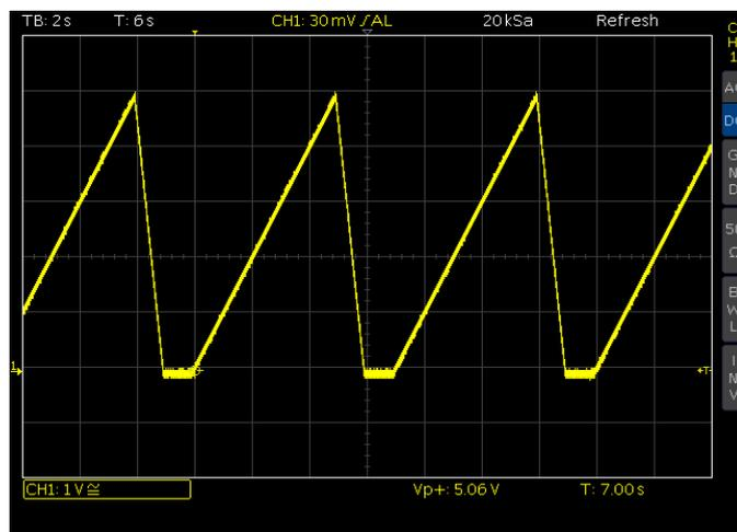
Abb. 5.10: Arbitrarybeispiel Oszilloskop mit Interpolation
