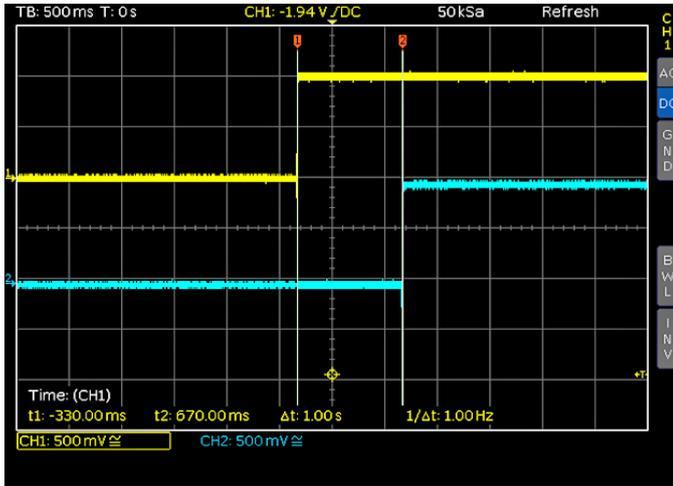
Abb. 6.6: Delay zwischen CH1 und CH2
