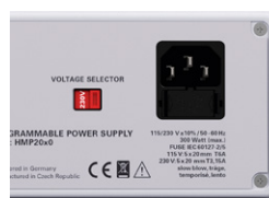
Abb. 1.1: Netzspannungswahlschalter beim HMP2030
