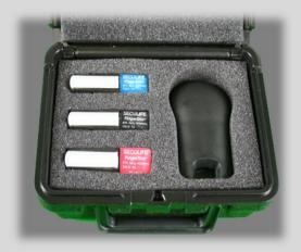
Das FingerSim Pulsoximeter-Prüfsystem ermöglicht es Pulsoximeter und Sensoren unter drei simulierten Lichtabsorptionsbedingungen zu testen. Diese Absorptionsbedingungen sind so angelegt, dass sie einen typischen SpO<sub>2</sub> Gehalt (Sauerstoffsättigung) imitieren.
