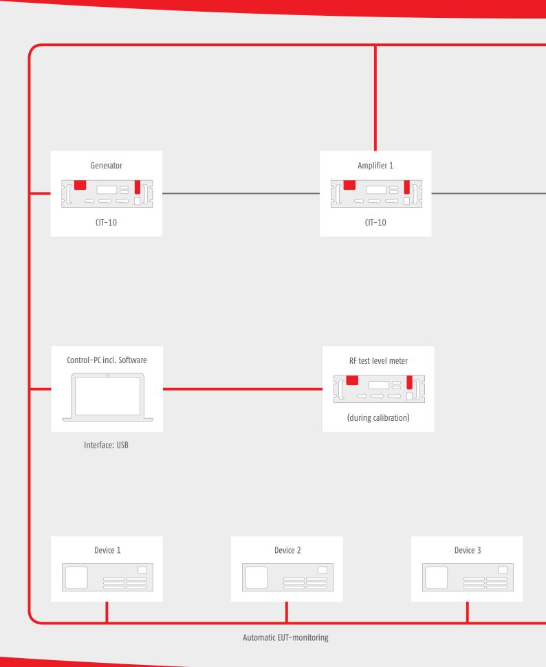
**CIRCUIT DIAGRAM OF A TEST SYSTEM**
