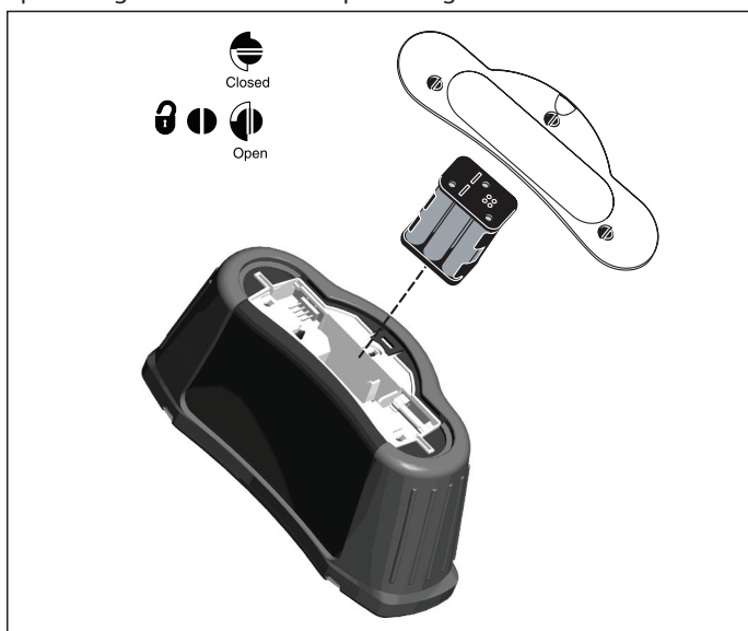
Figura 24. Sostituzione delle batterie
