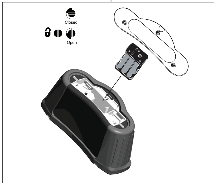
Figure 24. Remplacement des piles
