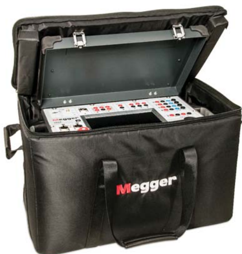
Componente portabile și compacte pentru un transport ușor. Trax 220, în valiza ușoară de transport cântărește mai puțin de 32 kg. Această geantă ușoară de transport este disponibilă ca opțiune.
