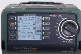
PROFITEST INTRO, este un instrument capabil de a efectua toate măsurările pentru evaluarea eficacității măsurilor de siguranță specifice sistemelor electrice, conform IEC 60364-6 (DIN VDE 0100-600) și altor standarde locale specifice.
