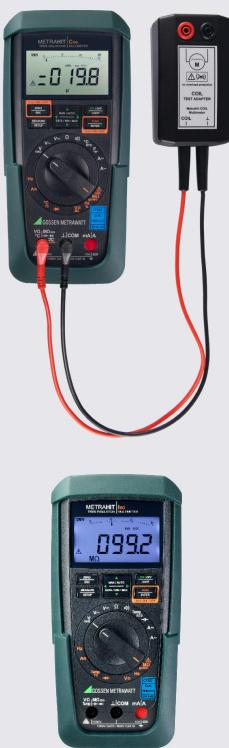
Multimetrele METRAHIT ISO și METRAHIT COIL sunt instrumente portabile robuste, potrivite pentru operațiuni de reparare a electrocasnicelor, mașinilor electrice (de exemplu, motostivuitoare) și sisteme electrice (de exemplu, instalații fotovoltaice). Instrumentele de teren sunt echipate cu o sursă de alimentare internă, independentă de rețea de alimentare. Măsurarea rezistenței de izolație cu detectia interferențelor și tensiunii de test: 50/100/250/500/1000 V
