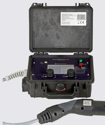
Instrumentul este conectat la stația de încărcare pentru a documenta comunicația dintre stația de încărcare și instrument. Dacă procesul de încărcare nu pornește, sursa erorii poate fi determinată rapid.
