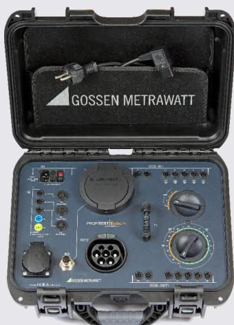
PROFITEST EMOBILITY este un adaptor pentru verificarea conform standardelor a cablurilor de încărcare monofazate și trifazate, mod 2 și 3, prin simularea defectelor.
