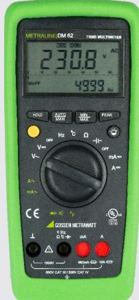
Multimetru digital portabil cu măsurare TRMS cu lățime de bandă de 100 kHz inclusiv, printre altele, funcții de măsură: V AC TRMS, V AC+DC TRMS, V DC, A AC TRMS, A AC+DC TRMS, A DC dB, Hz(V), Hz(A), Ω, V, °C / °F (TC/RTD)
