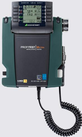
Aparat cu paletă largă de aplicații, se poate folosi în sist. electrice trifazate de curent alternativ, cu tensiuni între 65 și 500 V AC și frecvențe de la 15.4 la 420 Hz.
