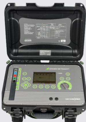
Instrumente de precizie ridicată pentru măsurarea rezistenței de dispersie a prizei de pământ și măsurarea rezistențelor de valori mici, inclusiv metodă de măsură pentru testarea sistemelor de protecție la descărcări atmosferice (paratrăsnăt)
