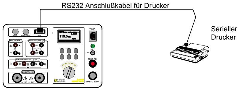
Abb. 28 - Anschluß eines seriellen Druckers an den C.A 6121 MASCHINEN-TESTER
