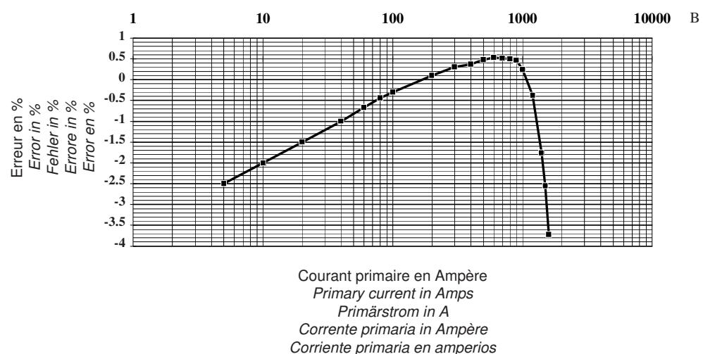
Courbe de déphasage typique en fonction d'un courant primaire alternatif 50 Hz
