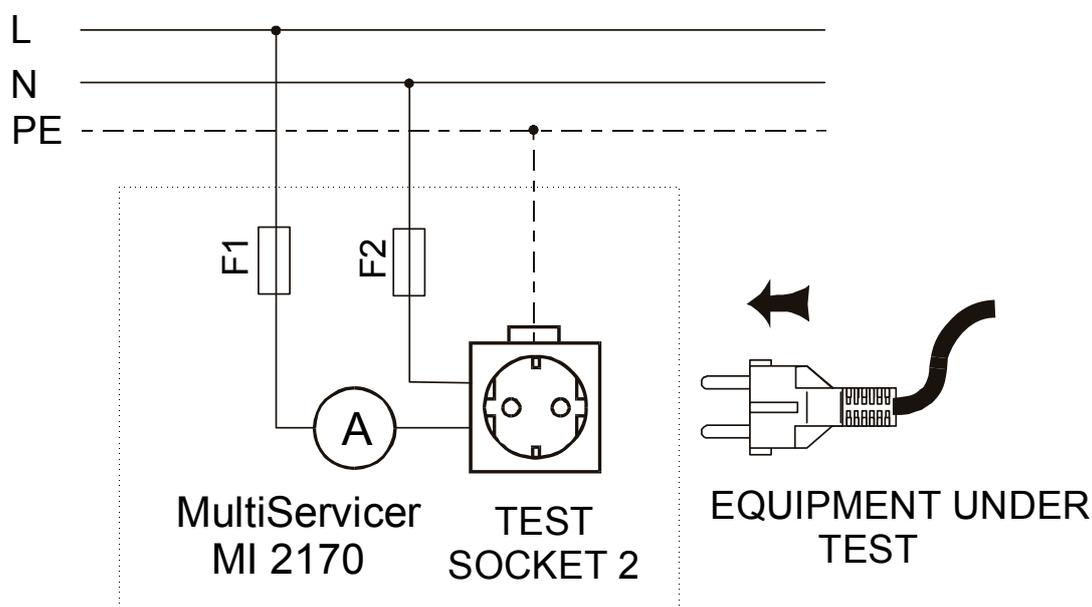
Fig. 25. Test circuitry
