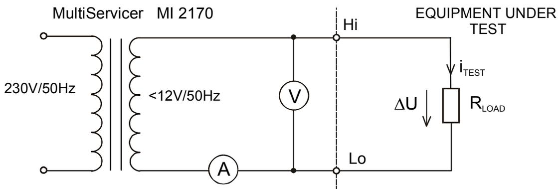
Fig. 16. Test circuitry
