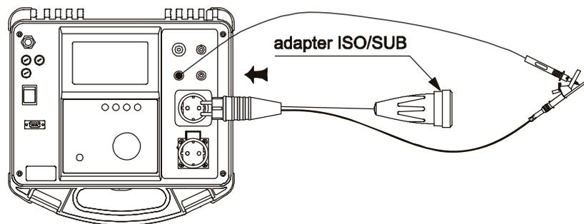
Fig. 56. Zero calibration
