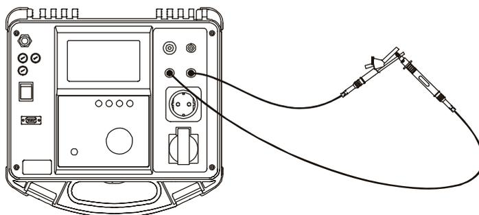
Fig. 14. Zero calibration
