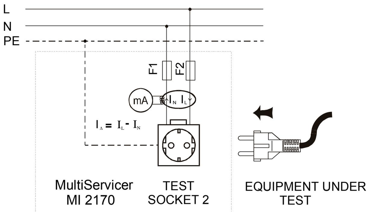
Fig. 29. Test circuitry
