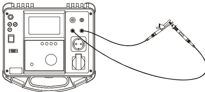
*Fig. 19. Zero calibration*
