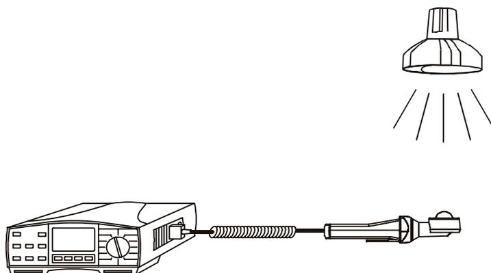
*Fig. 83. LUXmeter probe positioning*
