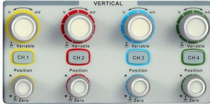
Les quatre voies des entrées analogiques sont marquées par des couleurs différentes qui sont également les couleurs d'affichage des formes d'ondes correspondantes à l'écran et celles marquant les connecteurs des voies d'entrée.
