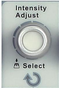
1. **Réglage d'intensité/luminosité de la grille/transparence de la courbe** : en mode de fonctionnement hors menu (menu masqué), tournez ce bouton pour régler l'intensité de la courbe (0 % ~ 100 %). Une rotation augmente la luminosité dans le sens horaire et la réduit dans le sens antihoraire. Vous pouvez également appuyer pour afficher
