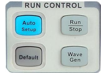
**Auto Setup** Appuyez sur ce bouton pour activer la fonction d'autosetup de la forme d'onde. L'oscilloscope ajuste automatiquement la base de temps horizontale, l'échelle verticale et le mode de déclenchement en fonction du signal d'entrée de manière à afficher la courbe dans un état parfait.
